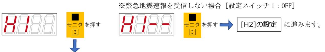
(ア) 音声(接点)出力時間を、「1分～9999分」で設定します。
