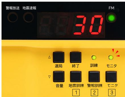
※「△選局ボタン」「▽音量ボタン」でライン出力音量の調節ができます。
