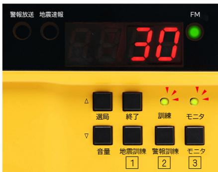
※「△選局ボタン」「▽音量ボタン」で本体スピーカー音量の調節ができます。
