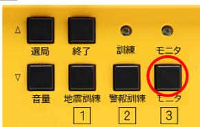
(2) 本体スピーカー音量が表示されます。(モニター LED(黄)：点灯)
