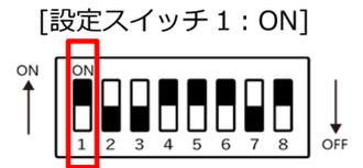
(ア) 音声(接点)出力時間を設定します。
