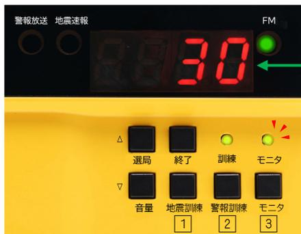
設定されているラジオ放送のライン出力音量
