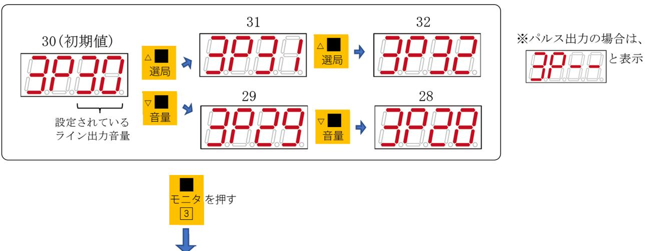
[4P] 「緊急地震速報の訓練メッセージ」のライン出力音量を設定
