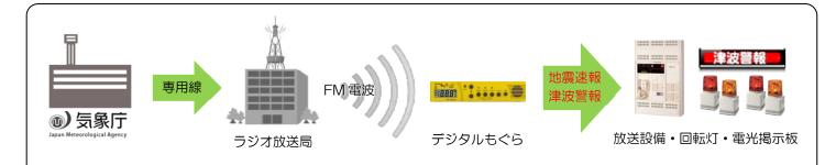
気象庁からの緊急地震速報・津波警報・自治体からの避難指示を、瞬時にFMラジオで受信し自動で館内に一斉放送! 最大予測震度が5弱以上(または5強以上)の地震で、放送エリア内に震度4以上の地域がある場合に放送!
