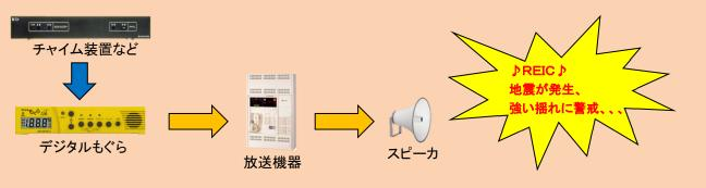
インターネット型受信装置と連動:インターネット回線が切断されても、デジタルもぐらの緊急地震速報を受信します。
